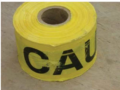
Caution Tape (Cinta de Atención) - For marking the Controlled Access Zone.
