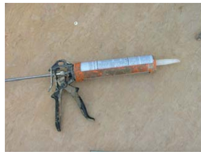
Sealant Tube Gun 10 oz. (Aplicador de Pegamento) - (Tube Style) Used to apply sealant.
