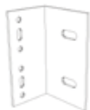
1 Ménsula de sustentación (Aluminio) Support Bracket (Aluminum)
