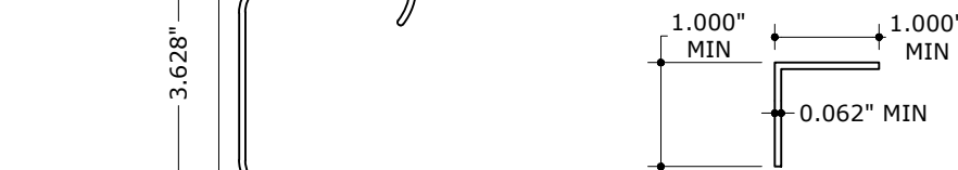
15 HV CORNER CENTERMATE N.T.S. 6063-T6 ALUM
