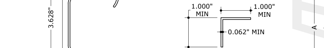
15 HV CORNER CENTERMATE N.T.S. 6063-T6 ALUM
