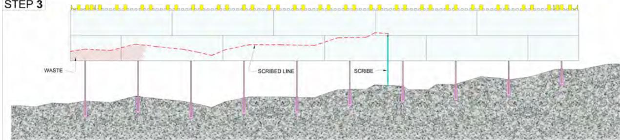
SCRIBE A LINE THAT FOLLOWS THE RELIEF OF THE BEDROCK (WOOD PLATFORM NOT SHOWN FOR CLARITY)
