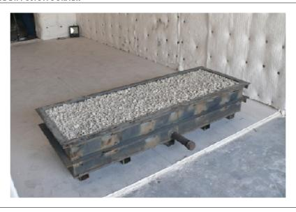
FIGURE X2-6 PICTURE ILLUSTRATING CERAMIC FIBER COVER AROUND PANEL PERIMETER
