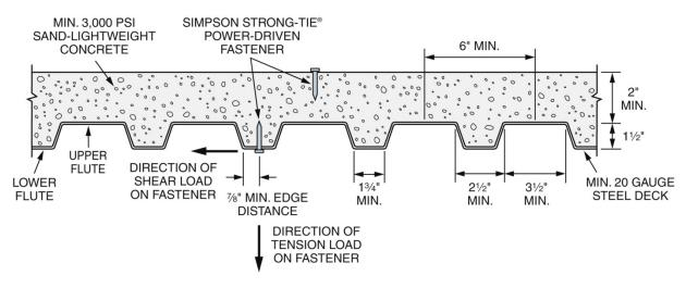
FIGURE 10—INSTALLATION IN 2-INCH CONCRETE FILL OVER 11/2-INCH-DEEP STEEL DECK
